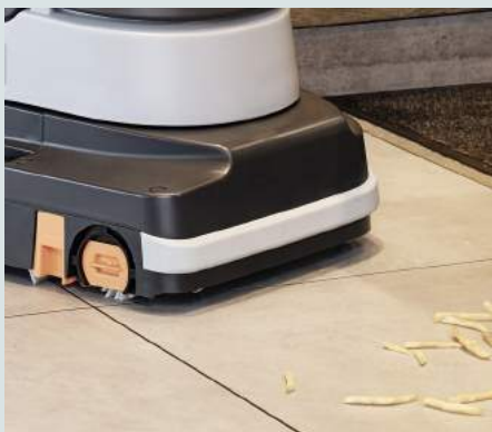
Ramassage facile de gros débris grâce à l'embouchure avant relevable
