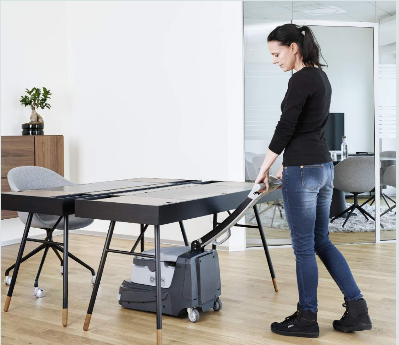
Poignée réglable : position fixe pour le nettoyage d'espaces aérés ou position flottante pour le nettoyage sous les meubles et les étagères
