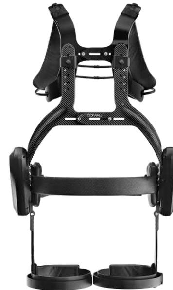
Grâce à une chaîne de degrés de liberté passifs, l'exosquelette permet toute la liberté de mouvement de l'utilisateur.
